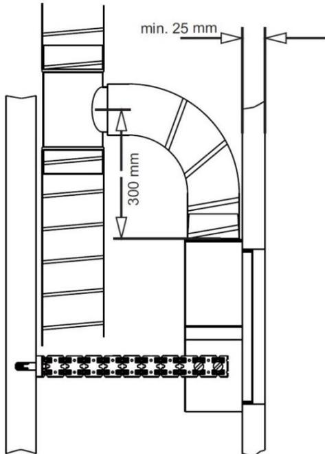
Wird das Gehäuse ohne Höhenverzug eingebaut, muss zusätzlich die Brandschutzklappe BU installiert werden. Bei Wohnküchen wird die Brandschutzklappe BU immer benötigt.
