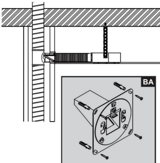
Durch eine Umlenkung von 2x 90° im Schacht und Höhenverzug von 300 mm wird der Brandschutz ebenfalls erfüllt. Die Brandschutzvorrichtung BA wird dann nicht benötigt.
